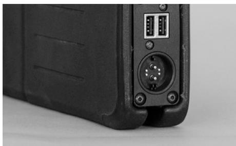
⚠ Recuerda que el conector de la batería es magnético y puede atraer objetos metálicos que pueden quedar en el conector.
