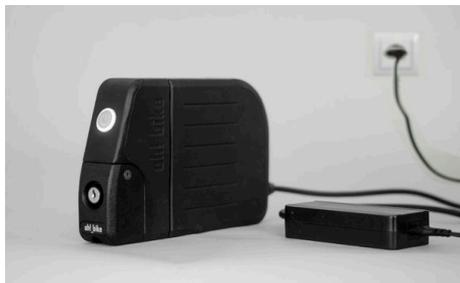
**2.** Conecta el cargador a la batería apagada. Se encenderá una luz verde intermitente, que mostrará el nivel de carga actual. Cuando la batería esté completamente cargada, esta luz se apagará.
