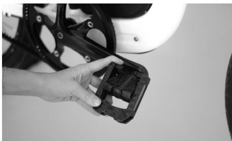
**2.** Manteniendo el pedal presionado, gira el pedal hacia arriba o hacia abajo.
