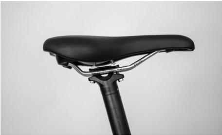
**2.** Para ajustar el desplazamiento y el ajuste de la inclinación del sillín debes abrir los tornillos del cabezal del sillín.
