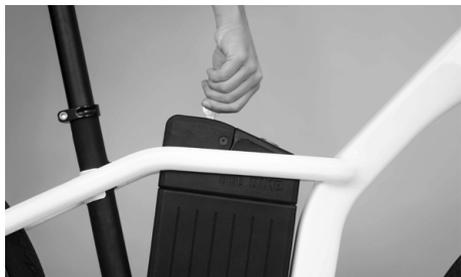
**2.** Con la llave todavía introducida en la cerradura, mueve la batería girándola hacia el exterior entre los tubos superiores.
