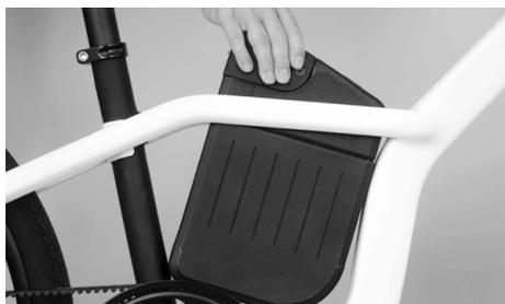
**1.** Encaja la batería entre los dos tubos superiores girando sobre la rótula delantera y déjala caer, encajando la parte trasera.
