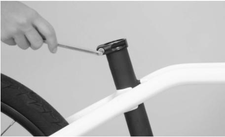
**1.** Para ajustar la altura, abre el tornillo de fijación de la sujeción de la tija del sillín, coloca la tija en una altura en que te sientas cómodo y vuelve a atornillar el tornillo.
