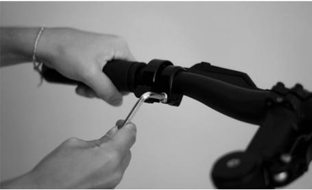
Comprueba que las manetas de freno están en una posición cómoda para ti. Si no es así, ajústala soltando los tornillos.
